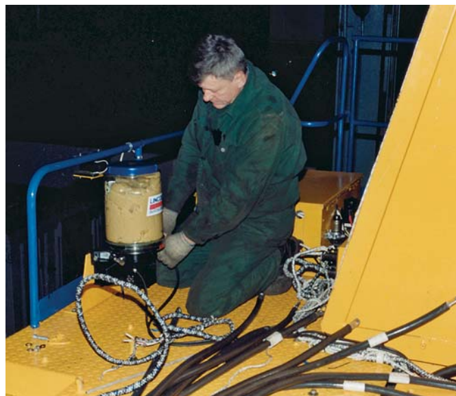
Установка АЦСС Lincoln на серийных самосвалах БЕЛАЗ
