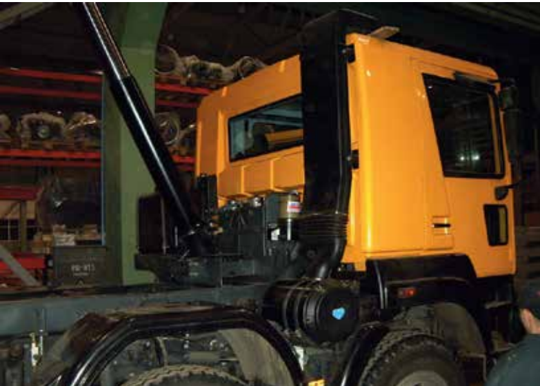
Монтаж автоматических систем централизованной раздачи консистентных смазок для передвижных ремонтных мастерских, оборудованных на базе автомобиля КА-МАЗ — 63501
