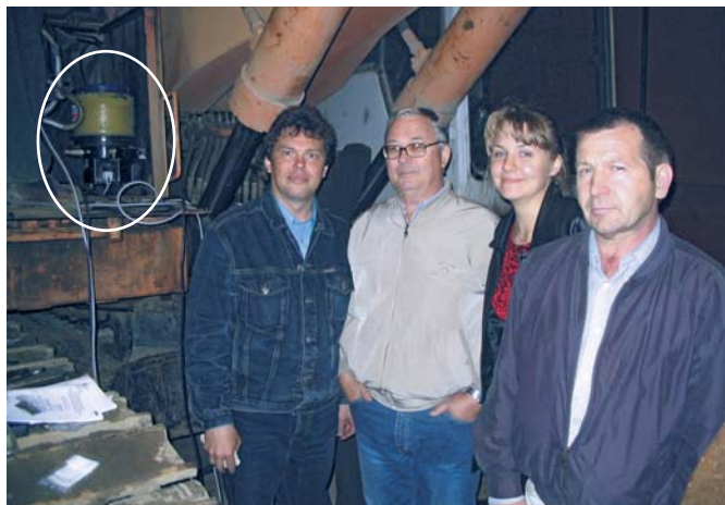
Размещение насоса тип Р 203 на экскаваторе ЭО-5126
